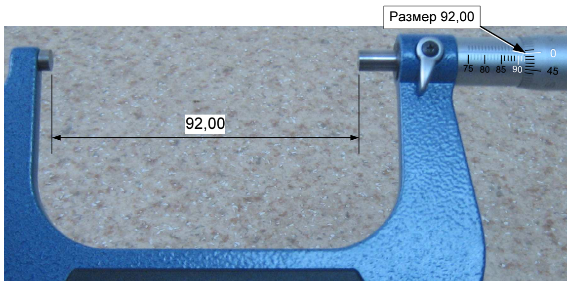
Рисунок 10. Грубая настройка нутромера (установка индикатора часового типа)
