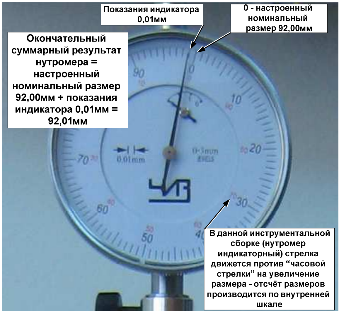
Рисунок 15. Отсчёт показаний нутромера
